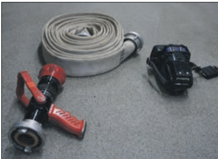
Mit Wärmebildkamera und Strahlrohr kommen nochmals 10,5 kg hinzu.
