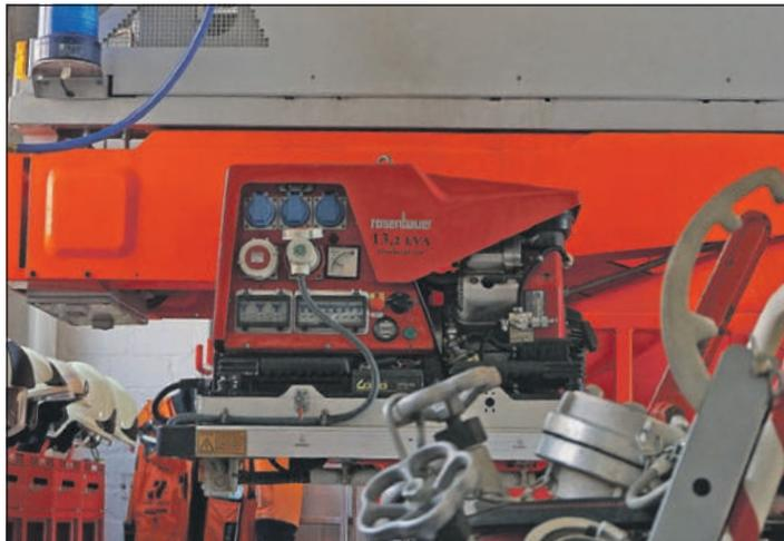
Einer von vier transportablen Stromgeneratoren auf den Fahrzeugen.
